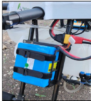
Fig. 6 : Battery set (Power source).
